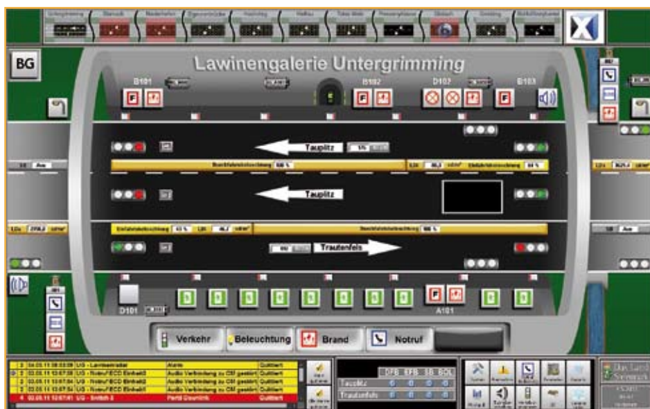
Overzichtssituatie van één van de tunnels die vanuit de controlekamer in Liezen in de gaten worden gehouden. Naar believen kan een heel tracé of juist een specifiek gedeelte worden afgebeeld.
